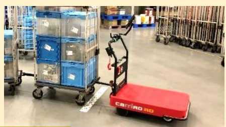
AGV（自動搬送ロボット）
